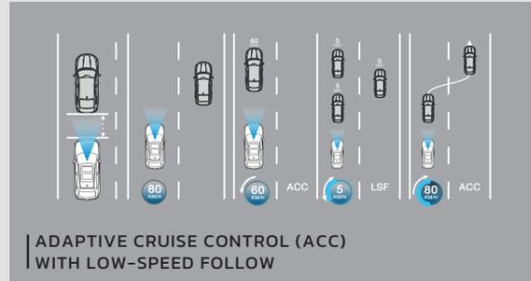
Membantu menjaga kestabilan kecepatan kendaraan dan mengatur jarak di belakang kendaraan yang terdeteksi di depan, dan membantu mengurangi kecepatan dan menghentikan kendaraan Anda, tanpa harus menginjak rem atau gas apabila kendaraan yang terdeteksi berhenti.
